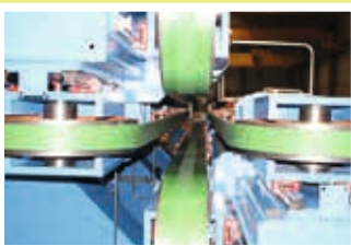
Single or double disc capstans / belt-type capstans / rotating pulling capstans Scheibenabzüge / Bandabzüge stationär oder rotierend Cabrestantes de tiro con simple o doble disco / cabrestantes tipo oruga, también rotativos Cabestans mono- ou double disque / chenilles et cabestans de tirage rotatives
