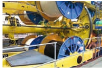
Cableadoras planetarias (con destorsión)
