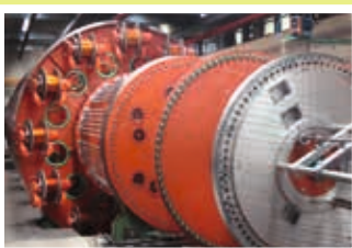
Transposed wire machines (CTC) Drilleiteranlagen Cableadoras planetarias para cables transpuestos Lignes de transposage
